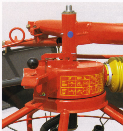
Lévier pour inverser le sens de rotation
