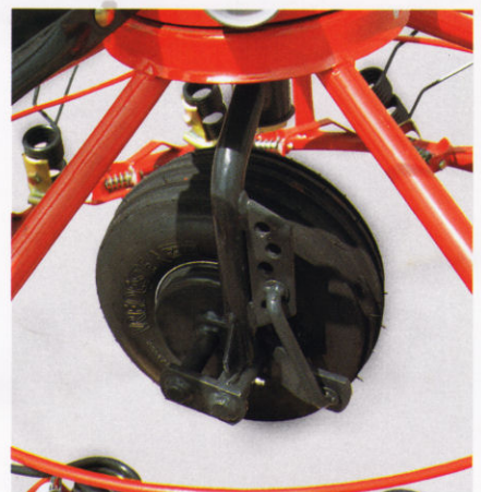
Réglage de la hauteur de ramassage par les roues
